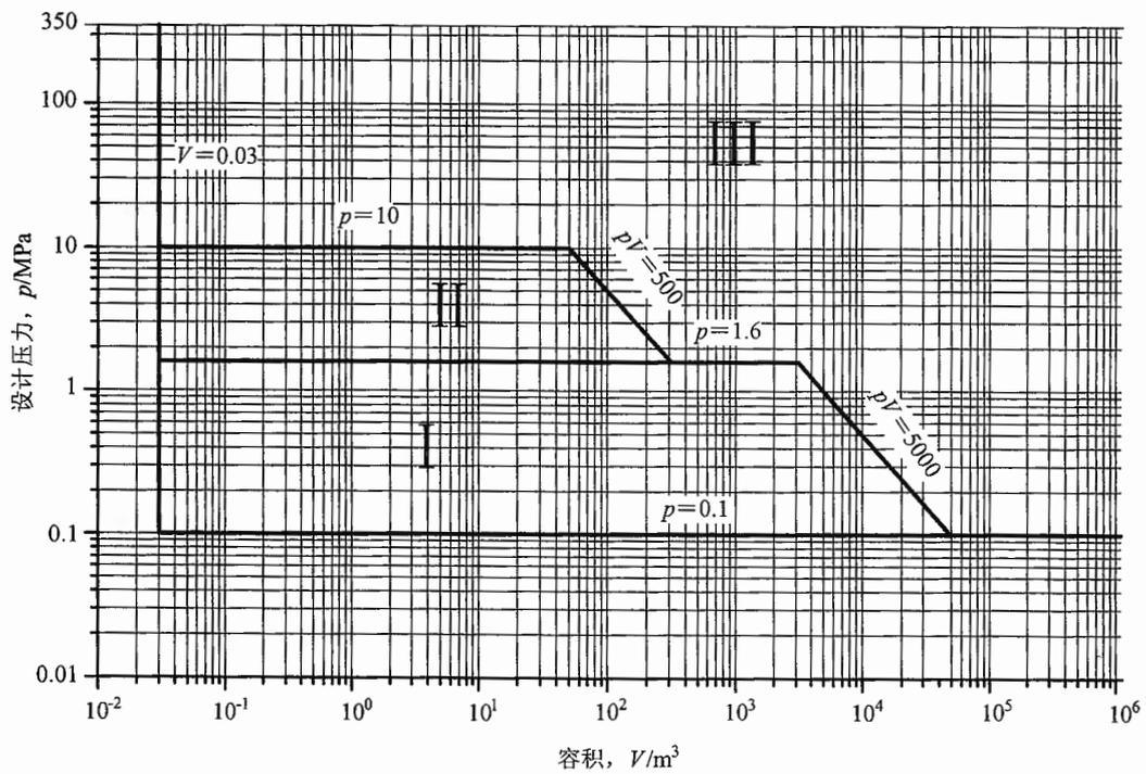
图 A-2 压力容器分类图——第二组介质
