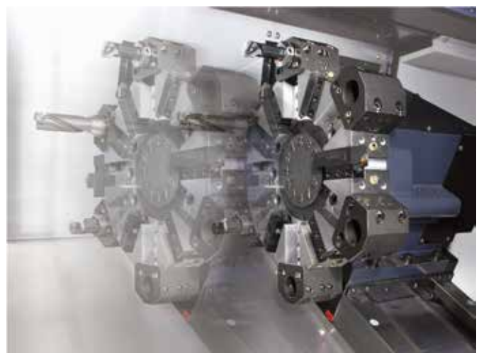
高效伺服电机驱动的全新设计的刀塔
