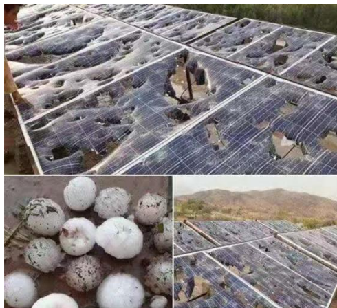
某光伏电站遭遇户外冰雹“袭击”，组件千疮百孔
