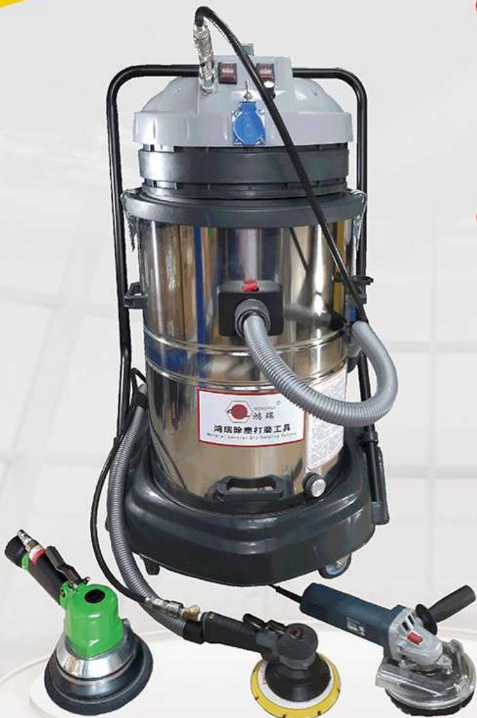
● 电动集尘机有两个专业的高流量工业吸尘电机，可长时间保持高流量真空吸力，确保电动角磨机打磨时有良好吸尘效果，电动角磨机和气动砂纸打磨机都可以自动控制集尘机开机和关机，打磨出来的粉尘直接吸取到集尘桶粉尘袋内，打磨机停止时电动集尘机延时10-15秒自动停机，吸力大小可以调节，节能省电
