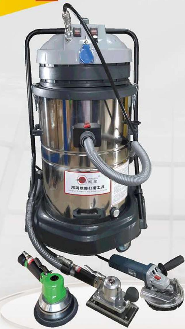
● 电动集尘机有两个专业的高流量工业吸尘电机，可长时间保持高流量真空吸力，确保电动角磨机打磨时有良好吸尘效果，电动角磨机和气动砂纸打磨机都可以自动控制集尘机开机和关机，打磨出来的粉尘直接吸取到集尘桶粉尘袋内，打磨机停止时电动集尘机延时10-15秒自动停机，吸力大小可以调节，节能省电
