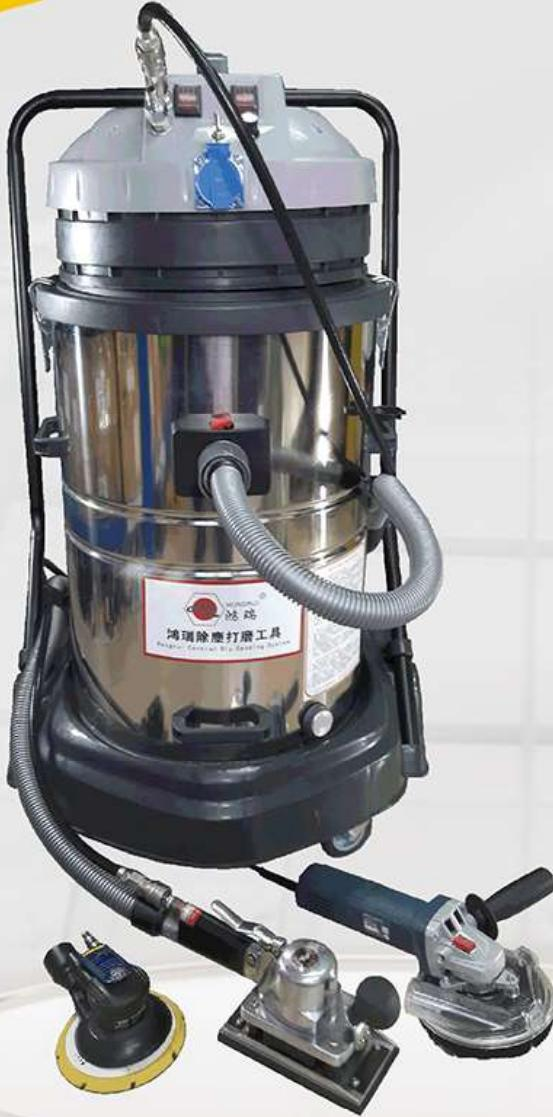
● 电动集尘机有两个专业的高流量工业吸尘电机，可长时间保持高流量真空吸力，确保电动角磨机打磨时有良好吸尘效果，电动角磨机和气动砂纸打磨机都可以自动控制集尘机开机和关机，打磨出来的粉尘直接吸取到集尘桶粉尘袋内，打磨机停止时电动集尘机延时10-15秒自动停机，吸力大小可以调节，节能省电
