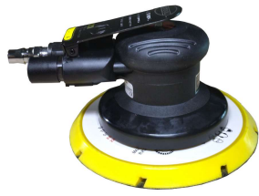
6寸静音小偏心精细砂光机 订货号: HR8101N 底盘直径: 150mm 偏心大小: 2.5mm 耗气大小: 60升/分钟 空转转速: 12000r. p. m 磨机重量: 0.73公斤 中途底漆和超精细平面打磨抛光
