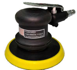
5寸低速打磨抛光机 订货号: HR3534 底盘直径: 125mm/无孔 偏心大小: 没有偏心 耗气大小: 200升/分钟 空转转速: 2400r. p. m 粘砂纸超精细平面打磨抛光, 粘抛光球镜面打蜡抛光
