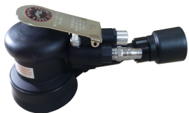
3寸中偏心打磨机 订货号: HR4001V 底盘直径: 75mm/3孔 偏心大小: 5mm 耗气大小: 200升/分钟 空转转速: 11000r. p. m 磨机重量: 0.7公斤
