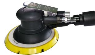
6寸中偏心砂纸打磨机 订货号: HR4122V 底盘直径: 150mm/15孔 偏心大小: 5mm 耗气大小: 200升/分钟 空转转速: 11000b. p. m 磨机重量: 0.87公斤 铁转子, 研磨力强
