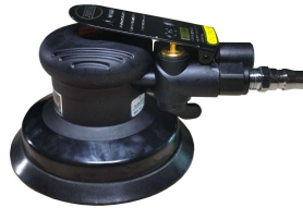
5寸静音小偏心精细砂光机 订货号: HR8001N 底盘直径: 125mm 偏心大小: 2.5mm 耗气大小: 60升/分钟 空转转速: 12000r. p. m 磨机重量: 0.7公斤 中途底漆和超精细平面打磨抛光
