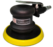
5寸高品质气动打磨抛光机 订货号: HR3534 底盘直径: 125mm 偏心大小: 无 耗气大小: 200升/分钟 空转转速: 2400r. p. m 机身重量: 0.8公斤
