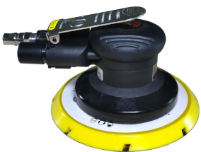
6寸静音中偏心砂光机 订货号: HR8102N 底盘直径: 150mm 偏心大小: 5mm 耗气大小: 60升/分钟 空转转速: 12000b. p. m 磨机重量: 0.73公斤 粘扣400号以下砂纸打磨
