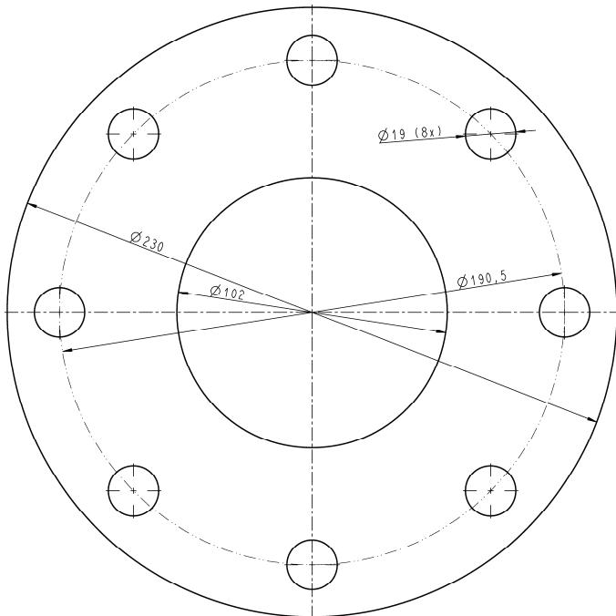
Falls ein kundenseitiger Prozessflansch mit einem Innendurchmesser von über 4" (101,6 mm) oder eine ungeeignete Dichtung verwendet wird, wird die Flanschverbindung anfällig gegenüber Undichtigkeiten.
