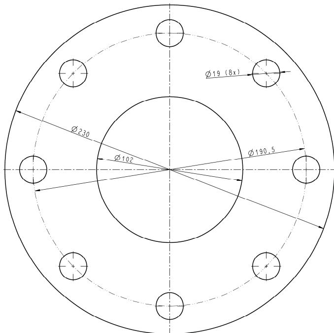
Si un client utilise une bride d'un diamètre intérieur de plus de 4" (101,6 mm), ou si un joint inadapté est utilisé, le raccord de la bride est susceptible de fuir.
