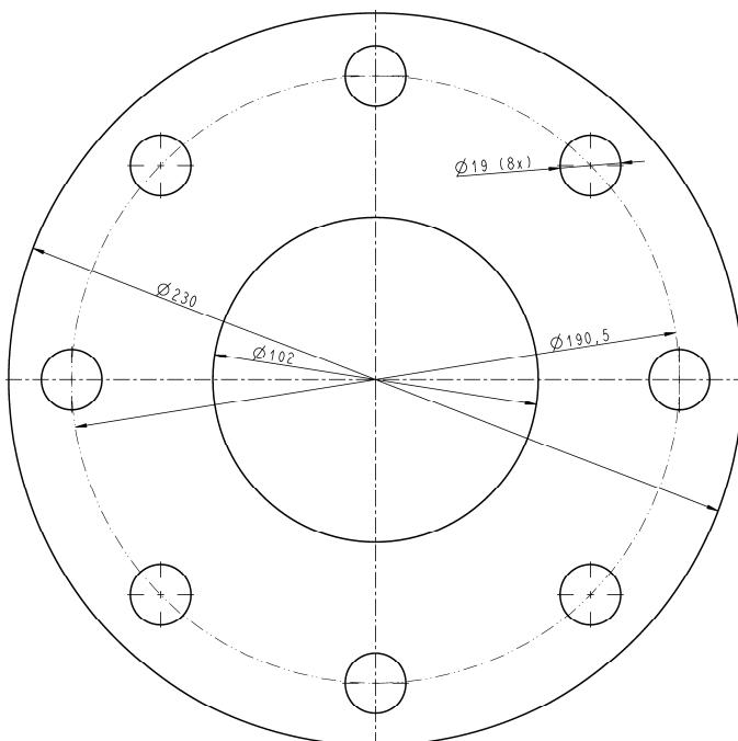
Si usa una brida de proceso de otro fabricante con un diámetro interno de más de 4" (101,6 mm) o una junta inadecuada, la unión embridada será propensa a presentar fugas.
