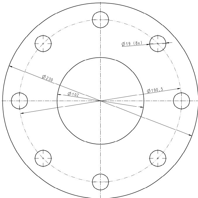
Se viene utilizzata una flangia di processo fornita dal cliente con un diametro interno superiore a 4" (101,6 mm) o una guarnizione non adatta, è probabile che si verifichino delle perdite in corrispondenza del giunto della flangia.
