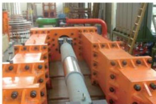
1000KN,3000KN阻尼器实验台
