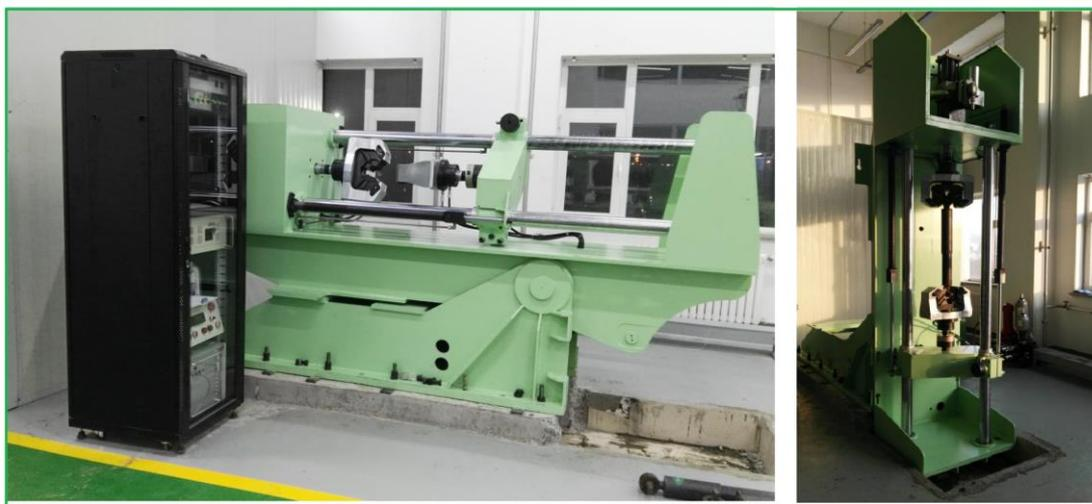
机车车辆减震器试验台
