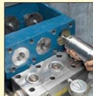
7 拆下铰链，并取下泵体
