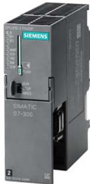
SIMATIC S7-300 CPU 315-2 PN/DP, 中央处理器, 带 384 KB 工作存储器, 1 个 MPI/DP 12MBit/s 接口, 2 个 以太网 PROFINET 接口, 带双端口交换机, 需要微型存储卡
