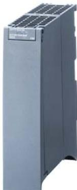
SIMATIC S7-1500, CM PTP RS-422/485 HF 通讯模块针对 串行连接 RS-422 和 RS-485, 空闲端口, 3964(R), USS, MODBUS RTU 主站, 从站, 115200 kBit/s, 15针 Sub-D 插座
