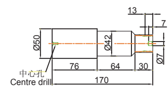
入力軸(C型) 尺寸圖 Input shaft (C type) dimensions
