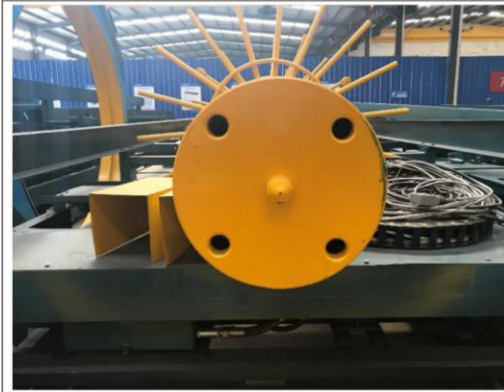
加粗上料架圆轴，直径达到 360mm，增强稳定性，牢固性。
