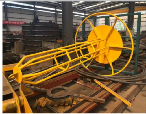
加长分料盘，防止钢筋脱落，保障工人安全。
