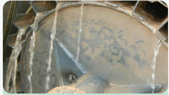
挤压区压滤出清水
