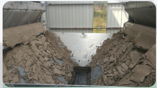
江门泰盛石场洗砂泥浆脱水效果
