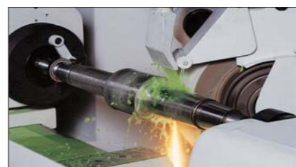
肩部研磨 工作物外由二頂心支撐，便可一次完成外徑及其肩部研磨。
