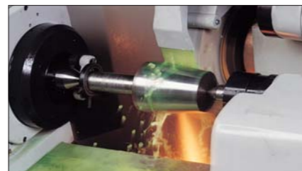
錐度研磨 錐度研磨的工件可由夾頭或二頂心支撐，工作台可易於配合操作旋轉工作台。
