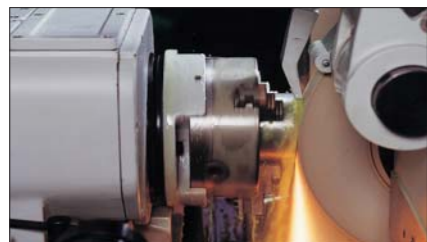
端面研磨 將工件固定在90°位置即可作端面研磨。
