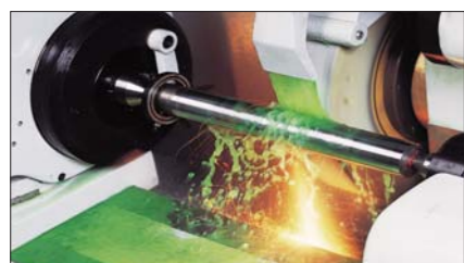
橫移進給研磨 自動間歇進刀和油壓驅動的工作台使工件得到最有效的橫移進給研磨。
