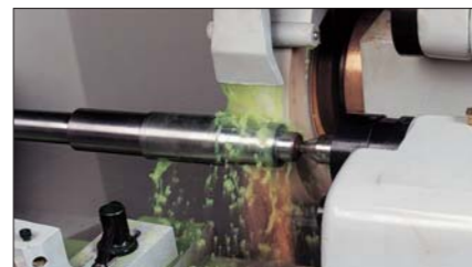
直進給研磨 自動進給能完成卓越短面研磨結果。
