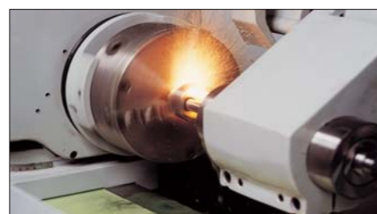
內徑研磨(選配) 研磨工件內徑，可使用懸臂式的內徑研磨裝置。
