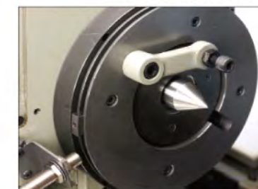
安裝在工作頭上之隱藏式感應器可確保快速量測及簡易送料。
