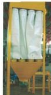
布袋除尘 Bag Dust Collector
