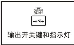
控制器输出受输出开关键控制,重复按此键,输出在ON/OFF之间切换。
